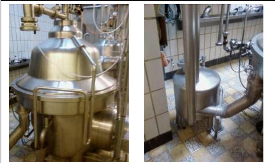
Abb. 12: Separator (links) und Auffangvorrichtung für Zentrifugenschlamm (rechts)
